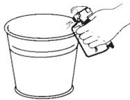
11. Appuyer sur la détente en visant le contenant métallique pour purger le solvant usé du pistolet, jusqu'à ce que du solvant frais en ressorte.
