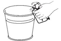
12. Appuyer sur la détente en visant le contenant métallique pour purger le solvant et l'air du flexible de vaporisation, jusqu'à ce que le produit de peinture s'écoule librement du pistolet.
